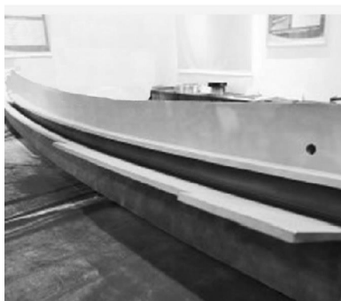
(a) C919 飞机中央翼缘条
